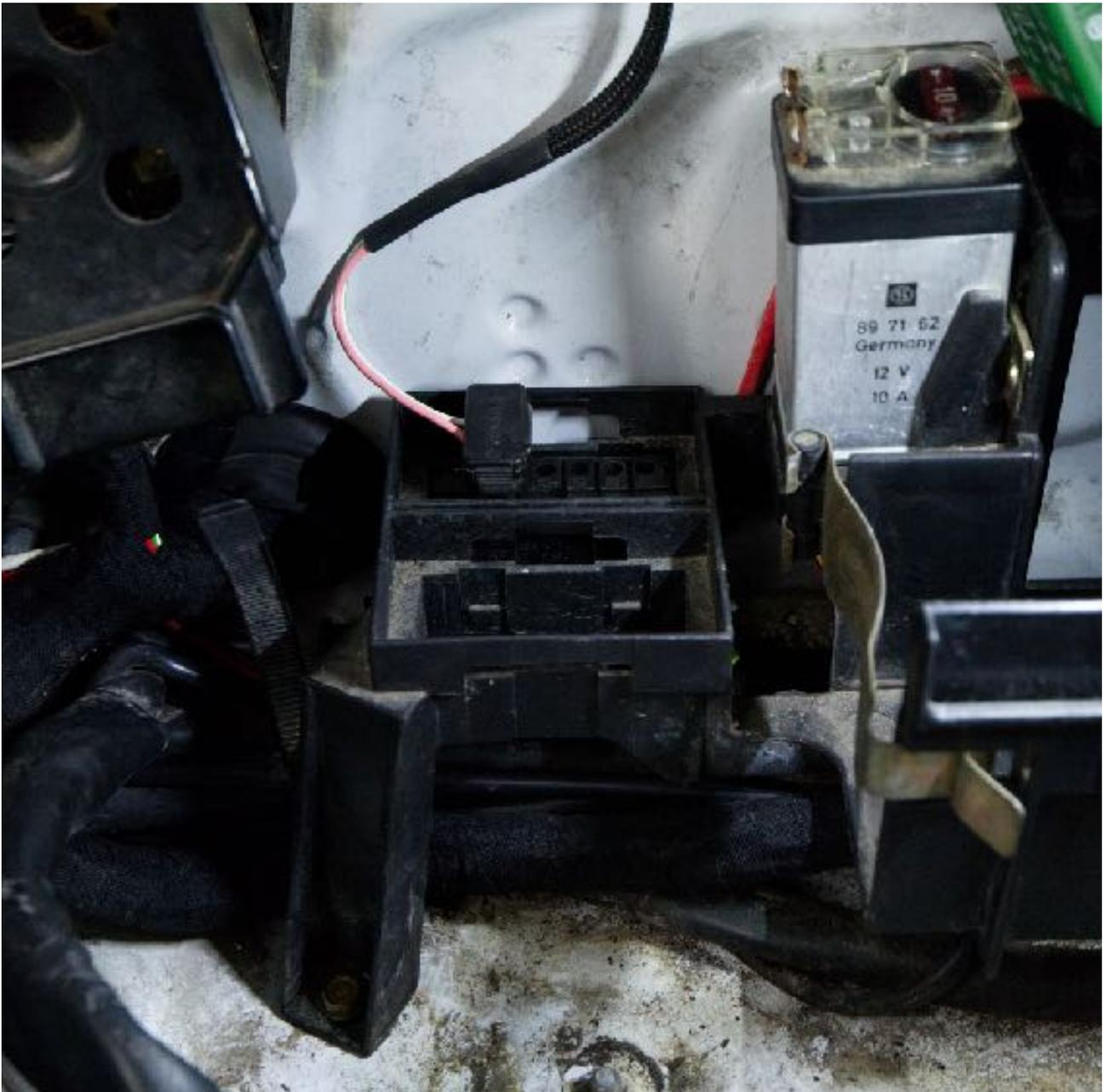
Die beiden Kabel (Stoff ummantelt) vom KPR Relais-Sockel ausspinnen & die Steckerhülsen in das mitgelieferte Relais einpinnen.
