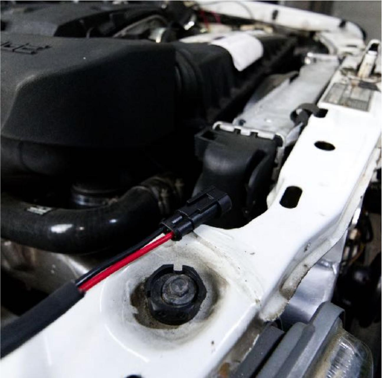
Ansaugluft-Temperatursensor (Luftmassenmesser entfällt)
