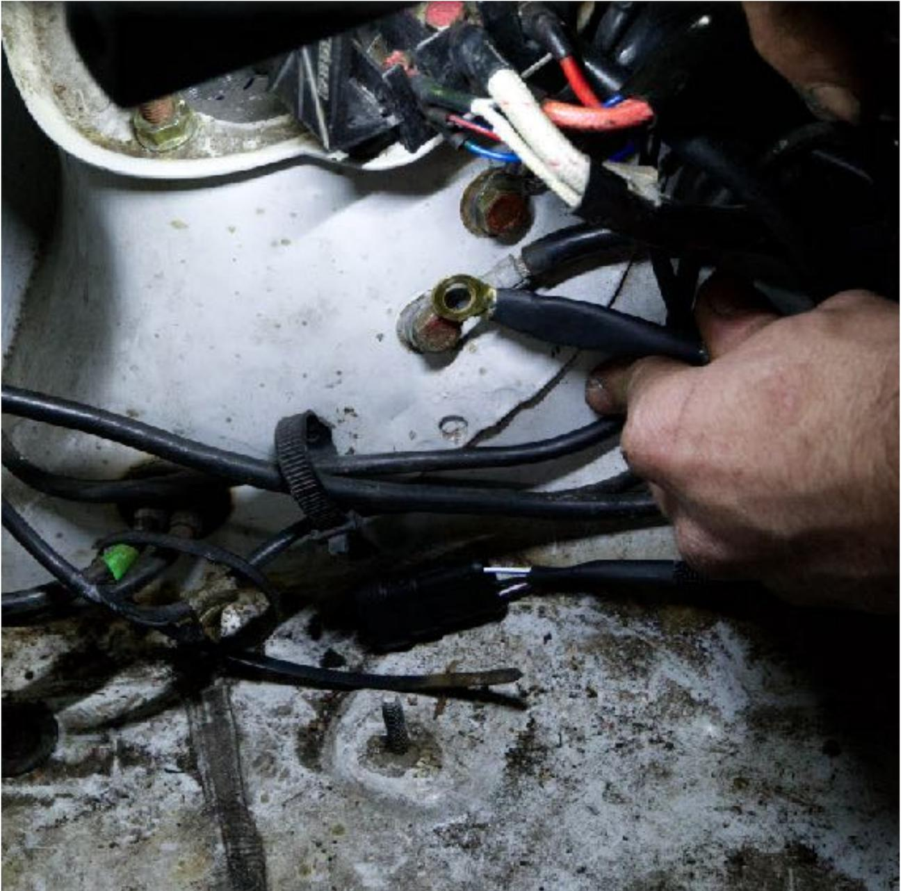
Plusleitung verbinden, dafür M6 Schraube lösen.
